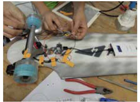
Longboard, bei dem während des Fahrens ein Akkupack aufgeladen wird.
